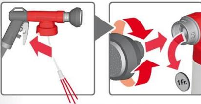
Handventil betätigen, Düse wird rückgespült
