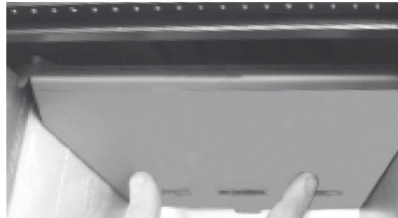
Abb. 6: Ziehen Sie die Feuerschutzwand hoch
