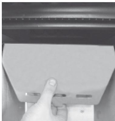
Abb. 8: Rotation der Feuerschutzwand
